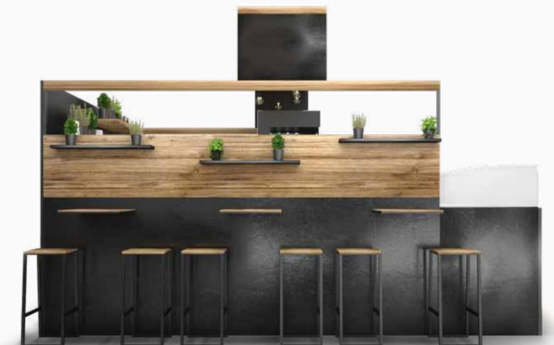
**Il pop-up store** si sviluppa in un'area di 3,50 x 4,00 metri. Al centro del bancone, in acciaio brunito, è **inciso il logo** retroilluminato. Lo spazio prevede **5 aree** per il consumo del pokè lungo i lati della struttura. L'ambiente è caratterizzato da colori e materiali tipici dell'industrial chic: **il legno e il metallo** sono i protagonisti della scena, creando un'ambiente **moderno, caldo ed accogliente**.
